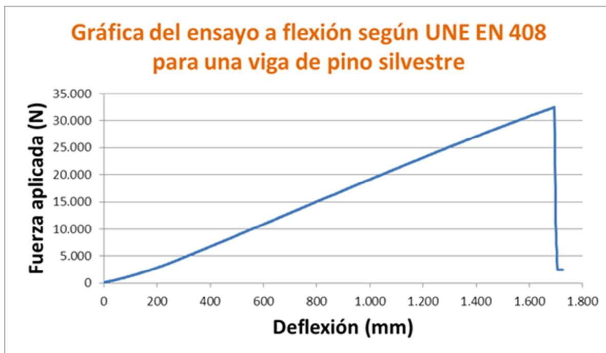
*Imagen 8. Gráfica del ensayo a flexión según la norma UNE EN 408 para una viga de pino silvestre. Como puede apreciarse, la relación entre deflexión y fuerza aplicada es muy lineal, hasta que se llega a la zona de rotura.*
