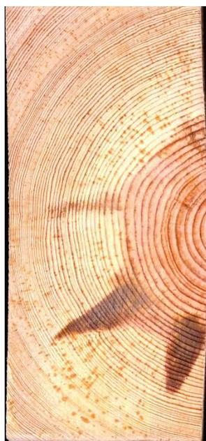
**Imagen 1.** *Imagen transversal de una de las vigas utilizadas en el proyecto, de pino negro o *Pinus nigra*, en la que se aprecia a simple vista el duramen (la parte semicircular) y la albura (el resto). La proporción albura/duramen es una de las variables utilizadas en la metodología.*
