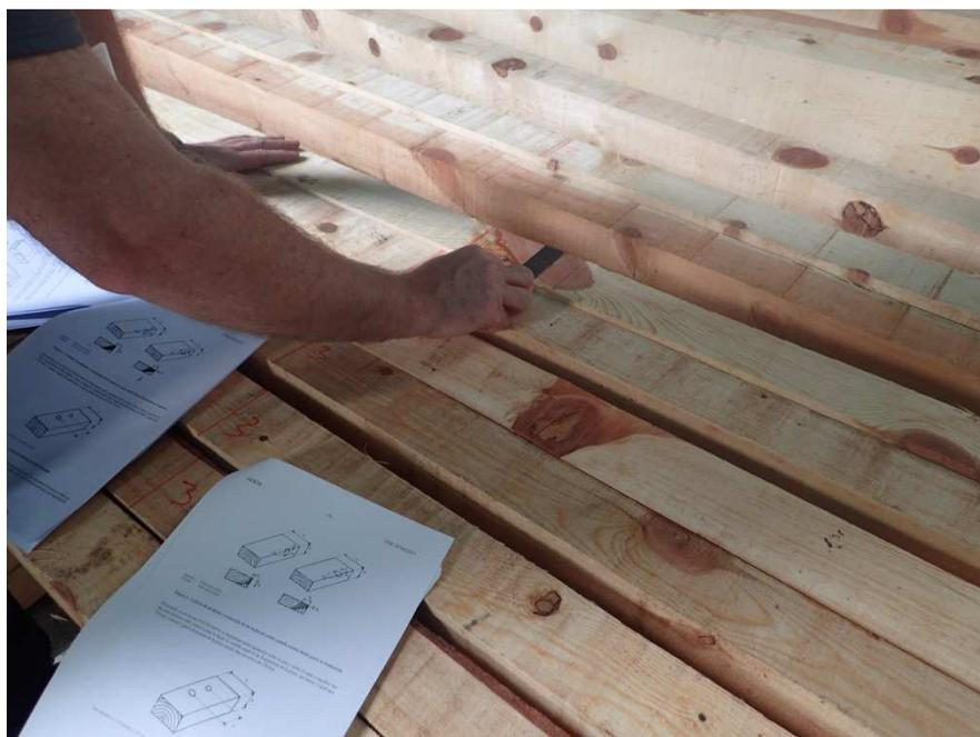
**Imagen 3. Inspección según criterios visuales: ubicación y medida de los nudos relevantes por tamaño en las vigas.**
