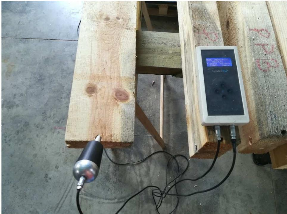
**Imagen 4. Evaluación no destructiva de la resistencia mecánica de las vigas mediante tecnología de emisión-recepción de ultrasonidos, analizada en la primera anualidad del proyecto.**
