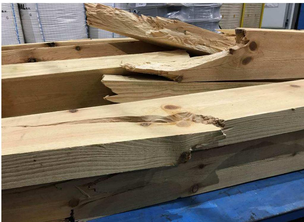
*Imagen 7. Algunas de las vigas rotas en el ensayo a flexión según la norma UNE EN 408. Normalmente la rotura se produce en zonas próximas a los nudos, debido a la desviación que sufre alrededor de ellos la fibra de la madera, que debilita su resistencia mecánica.*
