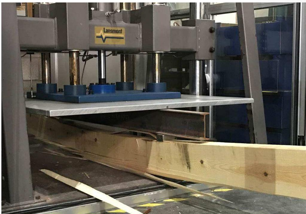
*Imagen 6. Rotura de una viga de pino silvestre en el ensayo de flexión según la norma UNE EN 408.*
